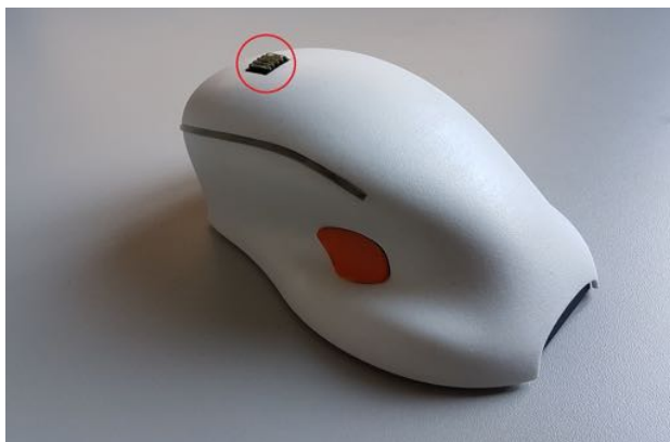
Abbildung 1: Computermaus mit taktilem Display
