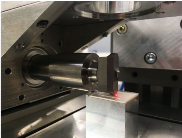
Abbildung 18: 40 kHz Schwingensystem für eindimensionale parallele und vertikale Anregung
