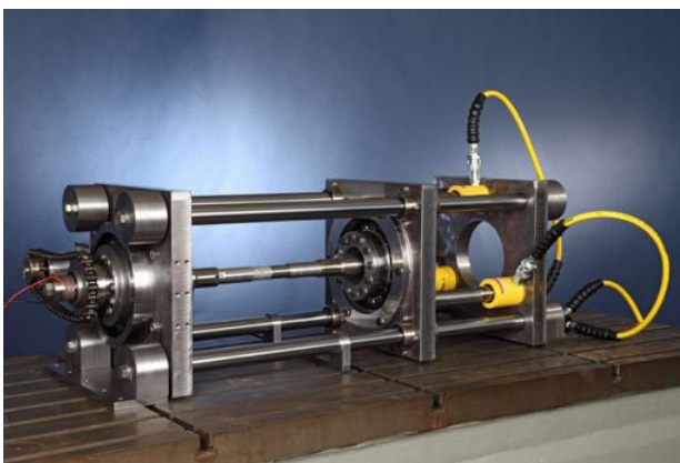
Abbildung 10: Anlage zum ultraschallunterstützten Laserstrahlschweißen
