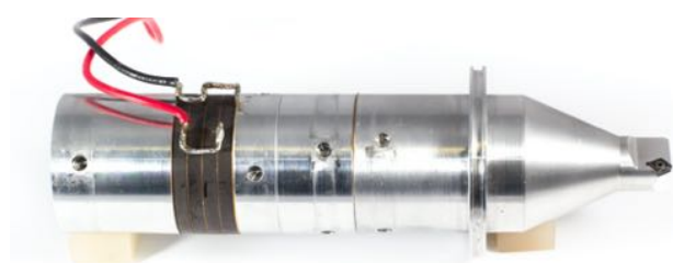
Abbildung 29: Prototyp eines Ultraschallwerkzeugs für den Einsatz in Drehmaschinen
