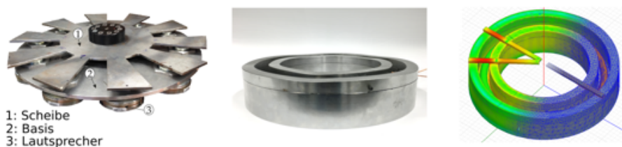
Abbildung 19: Akustische Anregung; Innovativer Anregungsmechanismus SINE; Magnetfeldsimulation
