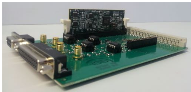
Abbildung 30: Hardware zur Ansteuerung von Ultraschallwandlern
