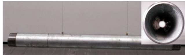
Abbildung 12: Experiment zur granularen Dämpfung im Labor: An Gitarrensaiten aufgehängtes Rohr mit geringer Menge Sand befüllt.
